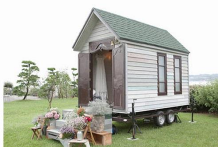
荷台サイズ：幅2250mm×3640mm 牽引免許必要タイプ ハウスは車台購入事業者が製作 ハウス素材：木製
