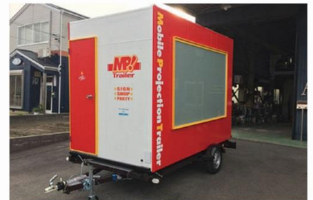
荷台サイズ：幅約1900mm×3040mm 牽引免許不要タイプ 当協会製作 ハウス素材：アルミフレーム+アルミ複合板
