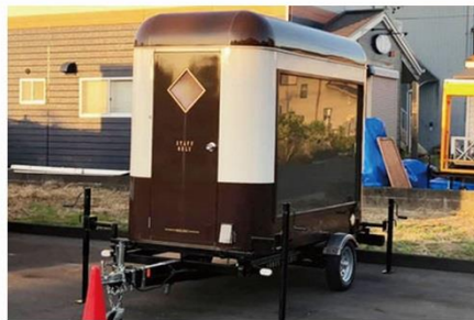
荷台サイズ：幅1290mm×2878mm 牽引免許不要タイプ 当協会製作 ハウス素材：アルミフレーム+アルミ複合板など
